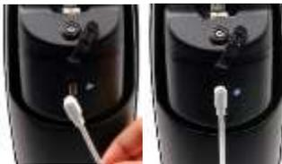
充電器を義肢または電源コンセントから外すと、振動で確認できます。キャップをしっかり閉めてください。金属粒子が磁化するリスクがあり、それがコネクタの接続に影響を与える可能性があります。
