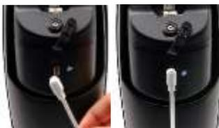
La desconexión del cargador de la prótesis o de la red eléctrica se confirma con una vibración. Cierre bien el tapón, ya que existe el riesgo de que las partículas metálicas se magnetizen e impidan que el conector se conecte correctamente.
