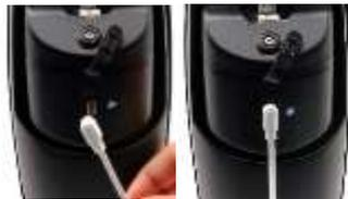
Das Trennen des Ladegerätes von der Prothese oder vom Netz wird durch eine Vibration bestätigt. Schließen Sie die Abdeckung sorgfältig, da die Gefahr besteht, dass Metallteilchen durch den Magneten angezogen werden und der Stecker nicht richtig schließt.
